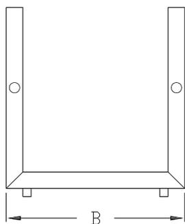
Grundgehäuse mit feststehenden Seitenteilen zum Einbau von Zusatzteilen (PG, Motorschutzschalter usw.)
