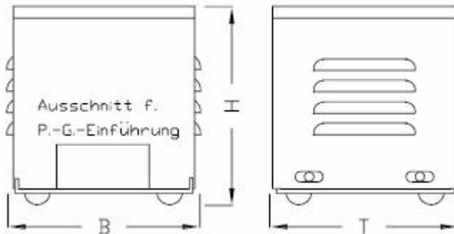
**Stahl-Blechgehäuse: Schutzart IP23**
